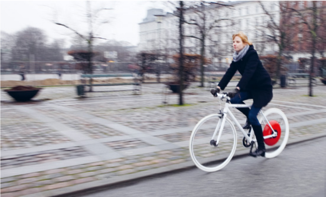
Das Copenhagen Wheel verwandelt jedes Fahrrad in ein smartes, hybrides E-Bike, das Energie erzeugt und umverteilt, während es urbane Daten erhebt. Ein Symbol dafür, wie Mobilität, Technologie und Freiraum miteinander interagieren können, um die Stadt von der Straße aus zu reformieren.
